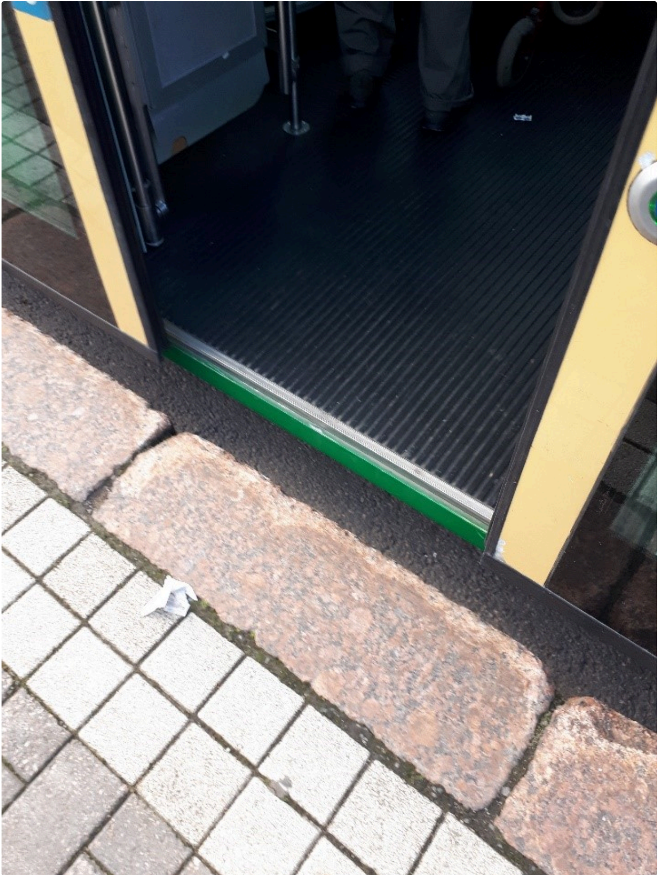
Ratikan ja pysäkin välinen 20 cm rako Hakaniemessä.
