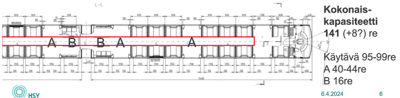
M200-vaunumallin pohjakuva. Kuva: Pääkaupunkiseudun kaupunkiliikenne Oy, muokkaus: HSY.
