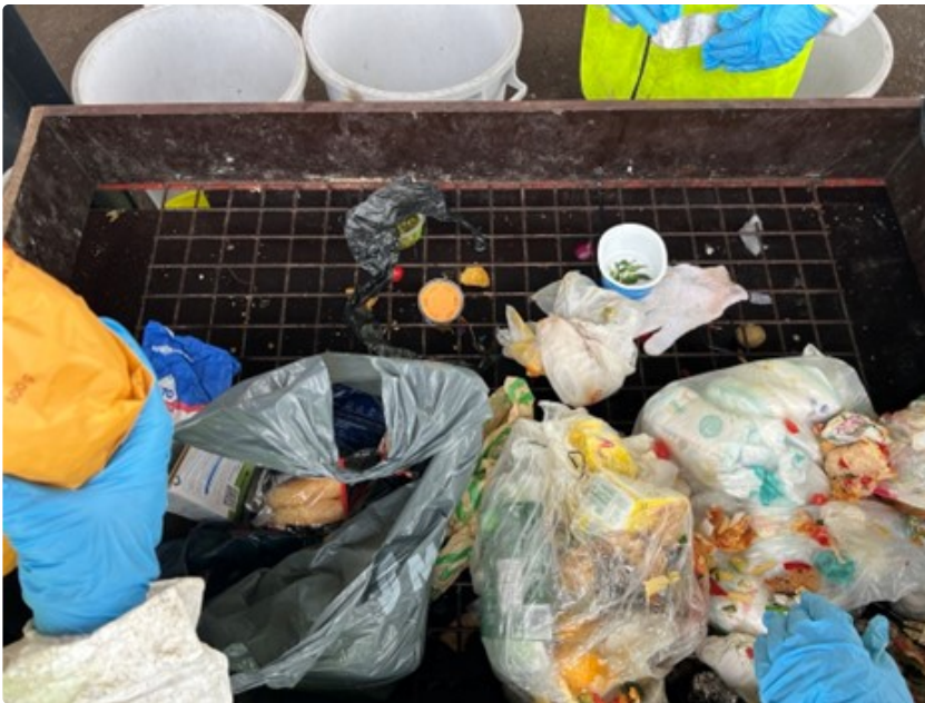
Kuva 5. Sekajätteen lajittelussa käytetty 50 mm seula lajittelupöydällä.
