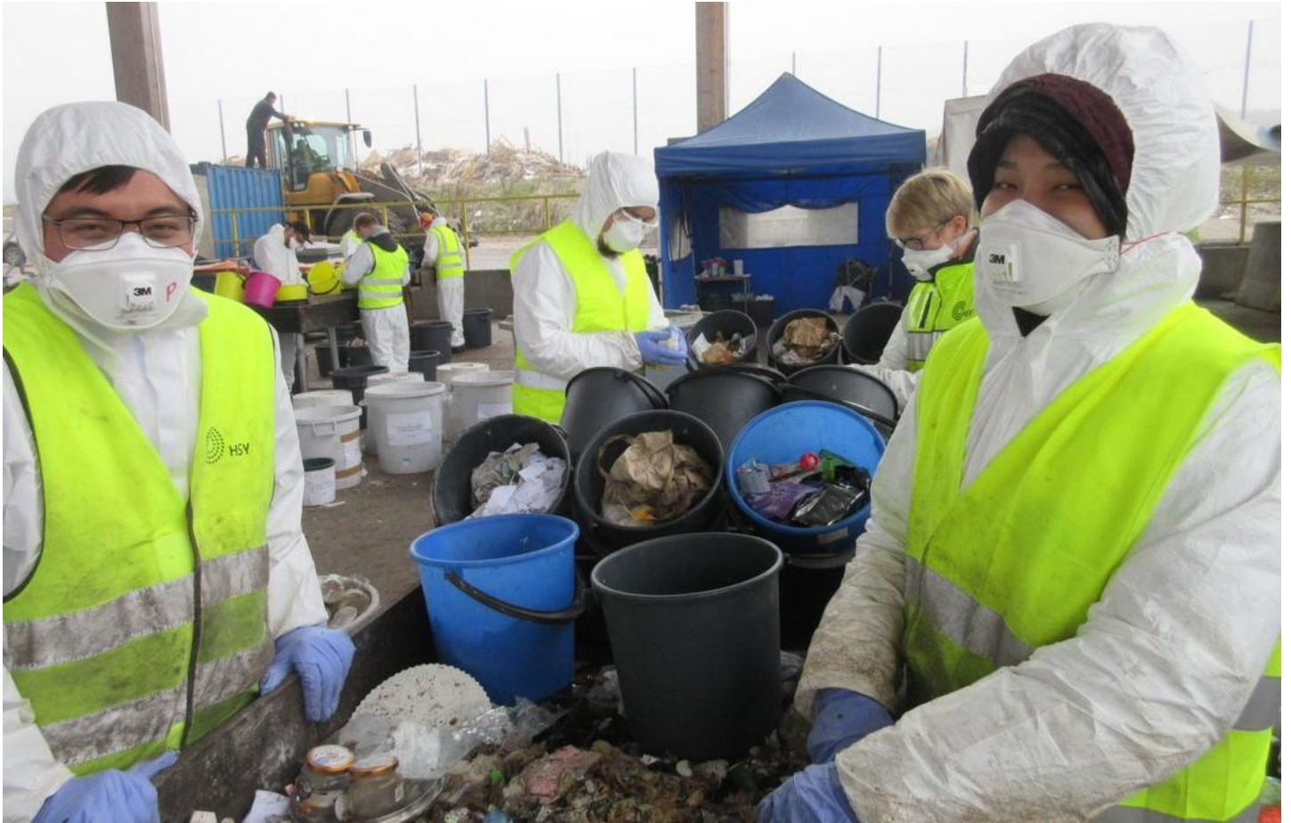
Kuva 4. Jätteen lajittelua lajittelupöydällä 50 mm seulan päällä.
