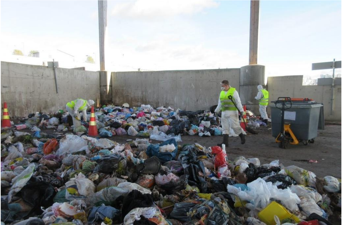
Kuva 2. Kokoomanäytteen keräys levitetystä tutkimuskuormasta
